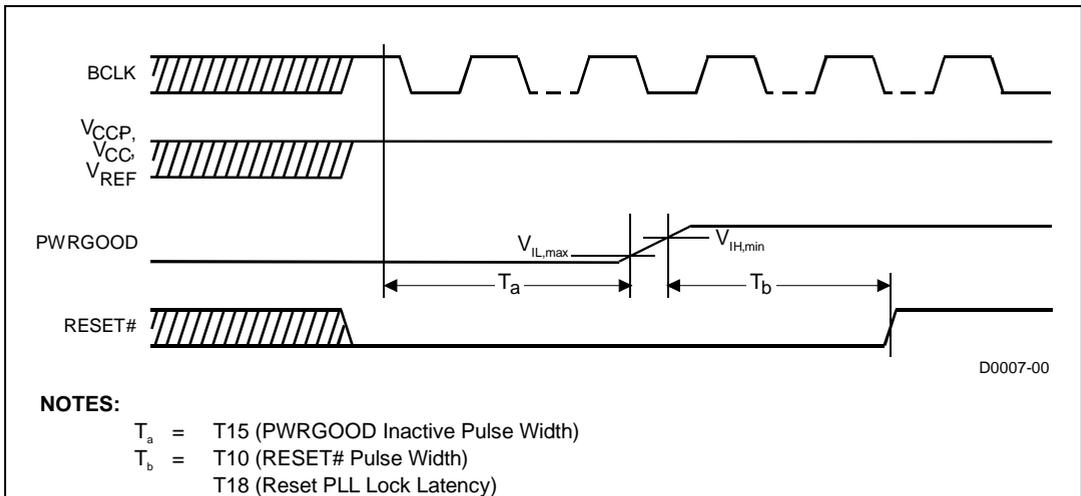
**Figure 3.6 Power-On Reset Timings**
