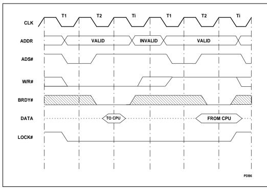
Figure 6-11. LOCK# Timing
