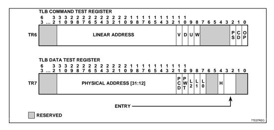
Figure 33-2. TLB Test Registers
